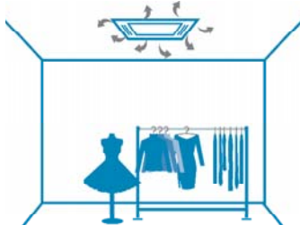
Rozkład powietrza z zabrudzonym filtrem
