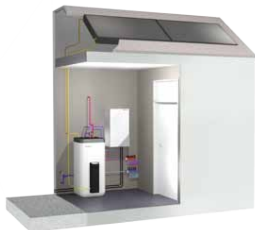
Jednostka naścienna połączona ze zbiornikiem akumulacyjnym ECH 2 O i kolektorami słonecznymi
