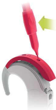
Rys. 37 Zdejmowanie osłony mikrofonu
