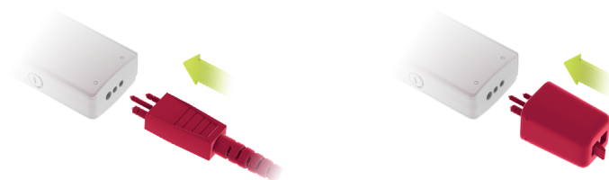
Rys. 41 Podłączanie przewodu adaptera i systemów Direct-link FM
