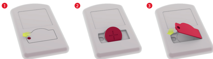
Rys. 48 Wymiana baterii w jednostce FineTuner
