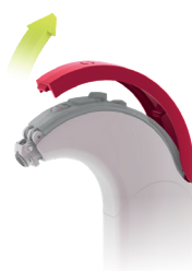
Rys. 39 Zdejmowanie osłony mikrofonu
