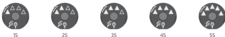
Rys. 9 Poziomy siły magnesów dla implantów SYNCHRONY
