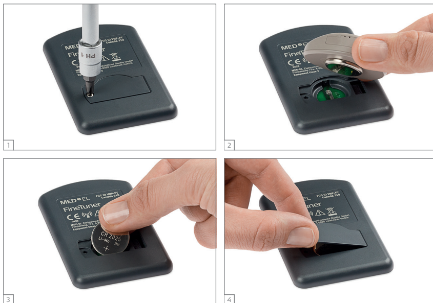
Rys. 17 Wymiana baterii w jednostce FineTuner
