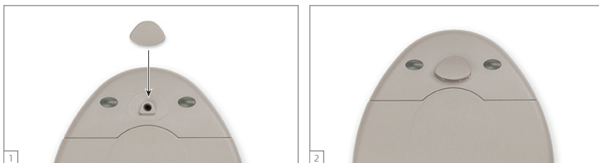
Rys. 13 Mocowanie osłony mikrofonu
