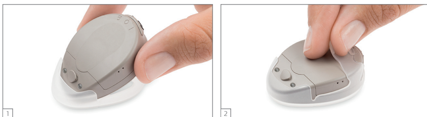
Rys. 12 Montaż osłony zabezpieczającej RONDO
