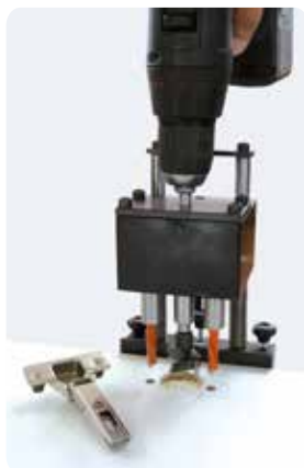
TRIMATIC 48/6 utilizzato con trapano portatile TRIMATIC 48/6 used with a portable drilling machine
