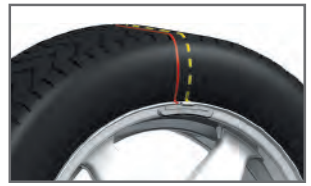
Możliwy błąd montażu ciężarka Possible positioning error
