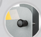
Blokada położenia stołu roboczego
