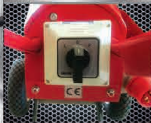
Przełącznik kierunku obrotów lewo/prawo Left / right direction switch
